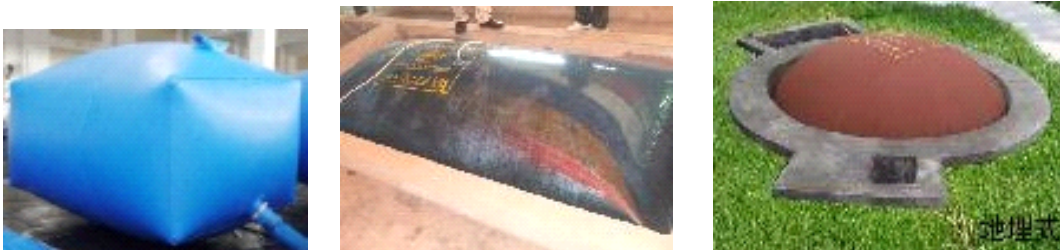
Rys. nr 14. Zbiorniki gazu w biogazowniach przydomowych
