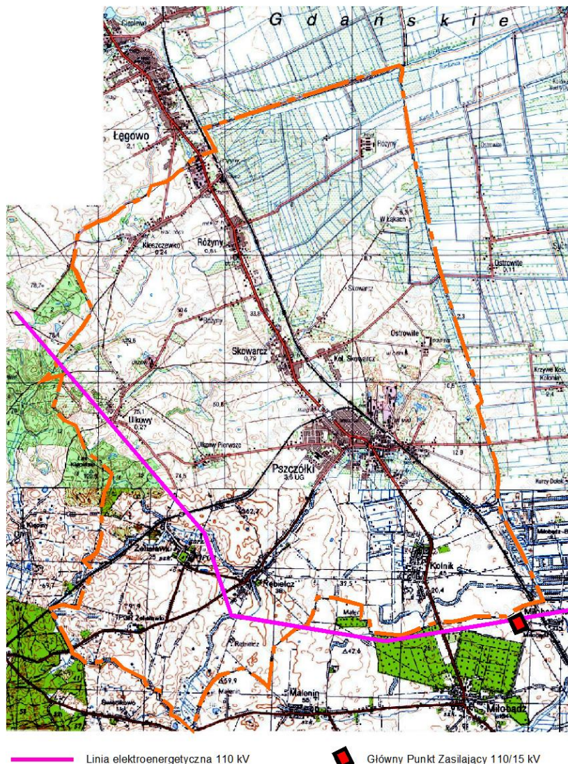
Rys. nr 7. Urządzenia elektroenergetyczne - stan istniejący - schemat
